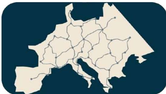
(a) Darstellung eines Verkehrsnetz als gewichteter Graph, wobei die Knoten Kreuzungen darstellen und die Kanten die Verbindungen darstellen. Das Gewicht der Kanten ist hierbei die Länge der Strecke.
