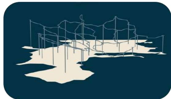
(b) Visualisierung der Heuristik Euklidische Distanz (Luftlinie) am Beispiel des Verkehrsnetz. Hierbei wird der Anteil der Heuristik an jeder Kante auf der z-Achse aufgetragen.
